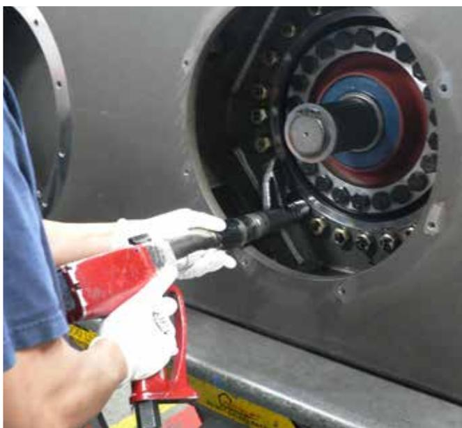
La prolunga TrukTorque™, una reazione speciale disegnata per serrare le viti delle ruote di camion e bus. Il Braccio si adatta facilmente ai copricerchi e ai bulloni delle ruote, anche se incassati in profondità.
