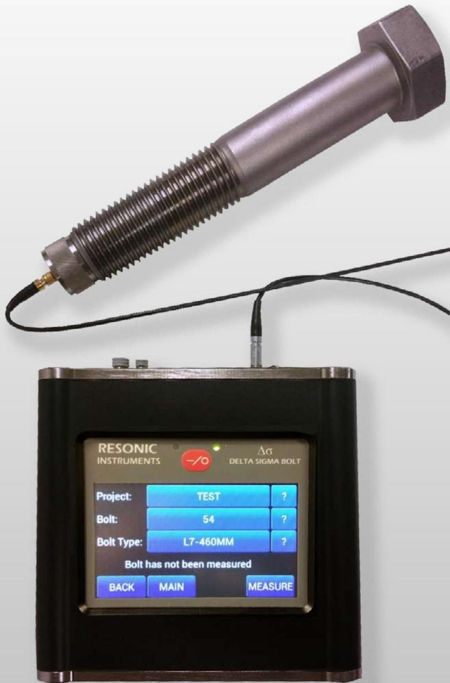
**DELTA SIGMA** è un nuovo **dispositivo a ultrasuoni** che permette di misurare, visualizzare, memorizzare e trasferire i dati relativi al carico e all'allungamento di viti e bulloni. Delta Sigma è costituito da un'unica e compatta unità elettronica dotata di un robusto **touch screen a colori da 4,3"**.
