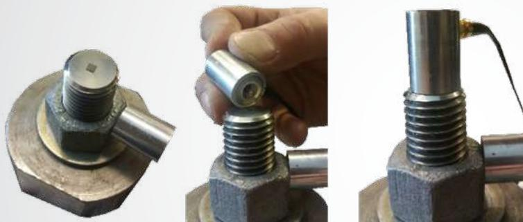
L'unità inoltre incorpora una sonda magnetica che permette una compensazione automatica della temperatura.
