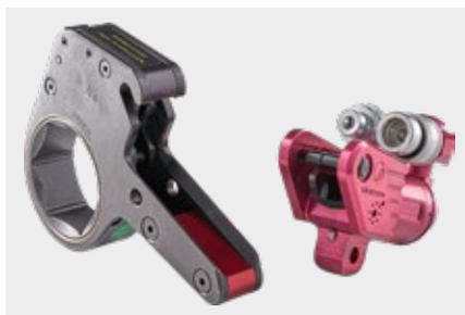
La serie XLCT è dotata di un cricchetto anti-scorrimento per un serraggio più potente e più rapido. La fila di denti secondari all'interno dell'utensile impedisce al cricchetto di girare in senso opposto alla direzione operativa.
