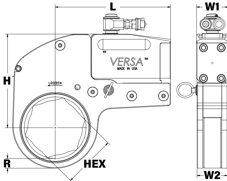
LEGENDA: H = ALTEZZA, L = LUNGHEZZA, R = DISTANZA DA BORDO, W1= SPESORE DEL CORPO, W2= SPESORE DELLA TESTA
