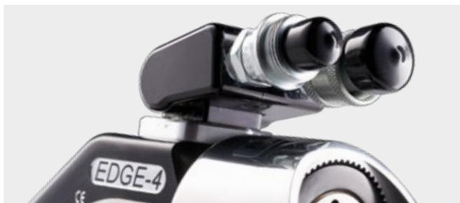
Il design a tre parti mobili di EDGE riduce al minimo il numero di potenziali riparazioni da effettuare sulla chiave e i costi operativi. La parte girevole multi-asse viene utilizzata su tutte le chiavi dinamometriche idrauliche HYTORC (ad eccezione di ICE) per massimizzare la capacità di posizionamento, la flessibilità e la sicurezza.
