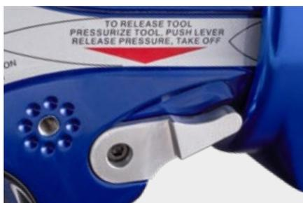
MXT è stato il primo strumento del settore a disporre di una leva di sblocco che consente di rilasciare lo strumento qualora si dovesse bloccare durante il serraggio. (Si trova anche nella serie AVANTI).
