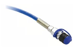
Le tubazioni idrauliche **HHSL** utilizzano robusti rinforzi a più spirali in polimero per alti livelli di sicurezza e di resistenza all'abrasione e ridotti raggi di curvatura per un collegamento più agevole. Ideali per tutti i dadi e i tensionatori idraulici TensionPro
