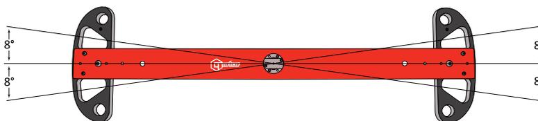
In più le aste devono essere utilizzate sulla verticale dell'attacco quadro del trasduttore. Questo minimizza il momento derivato dalla flessione del trasduttore e, per sicurezza, è bene assicurarsi che l'asta non fuoriesca dal quadro.
