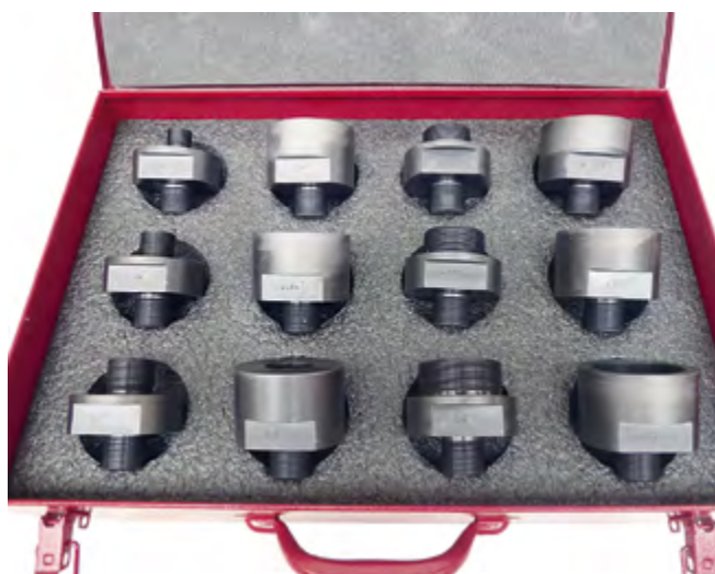
Adattatore di filetti per valvole con filettatura NPT e BSP
