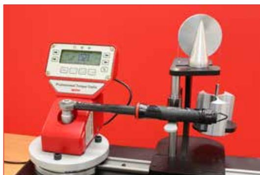
60323 Kit adattamento Pro-Test e trasduttori tipo a Blocco Smart STB
