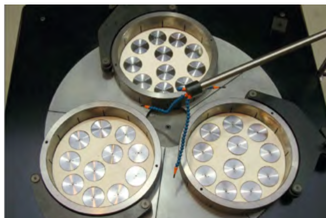
Anelli di condizionamento con parti in lavorazione
