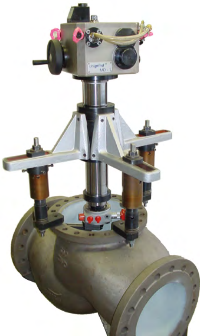
Lavorazione di sedi di valvole a sfera con MD 1
