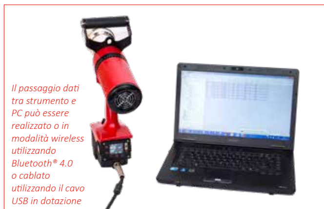
modalità Bluetooth® per il trasferimento dei dati in wireless
