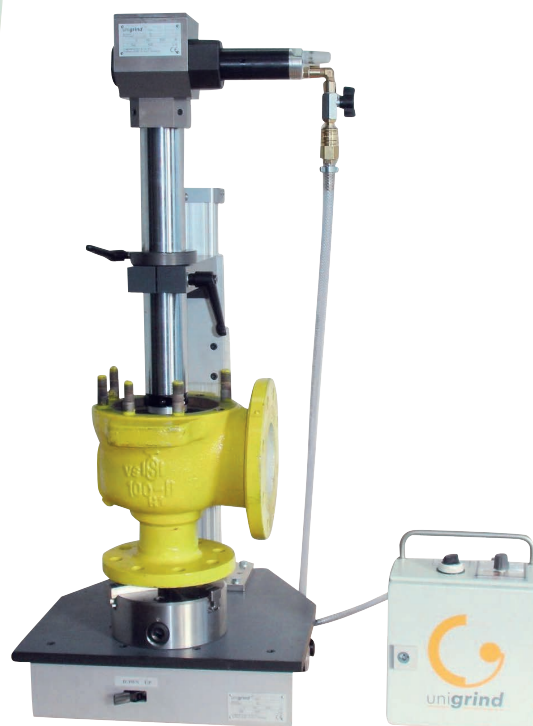
Smerigliatura di una valvola sul supporto della macchina SVS 1
